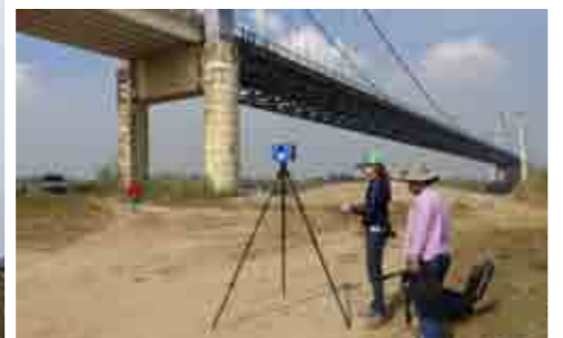
3Dレーザースキャナーで得たデータをコンピューターに取り込んで橋を3D化し、設計図面と比較して変形や斜度を算出。
